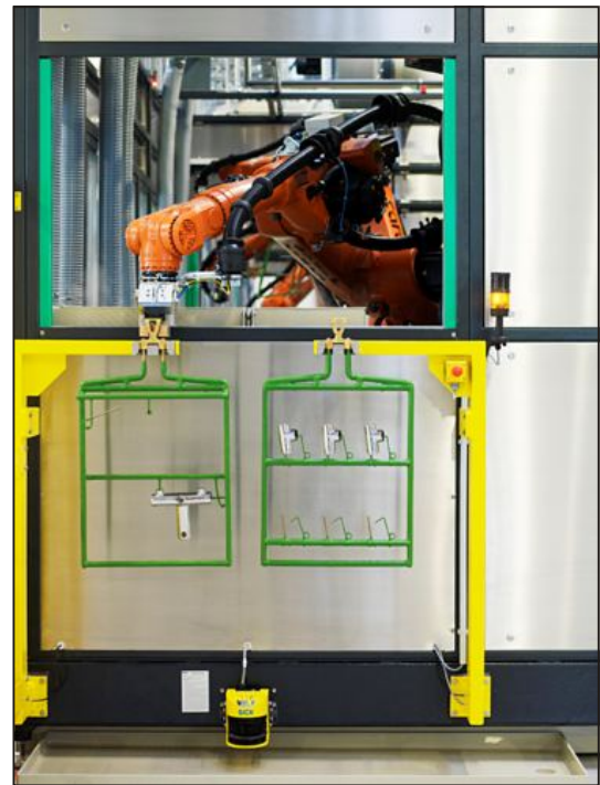
Bild 3: Übergabebereich des Roboters mit Gestellpuffer und Sicherheitstechnik
