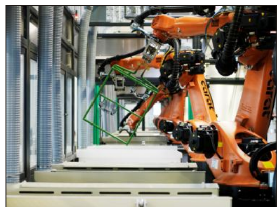
Bild 2: Die GAVAROLINE besteht aus drei Moduleinheiten mit insgesamt 6 Robotern. Aufgrund der Beweglichkeit können die Gestelle geschwenkt werden. Die Ver- schleppung von Restflüssigkeit wird dadurch extrem reduziert.
